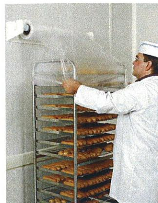
Le polyéthylène haute densité est fabriqué selon un procédé basse pression. Ses caractéristiques principales sont ses propriétés de résistance à la traction et la possibilité d'obtenir une housse d'une épaisseur très fine et d'un poids relativement faible. La matière première utilisée pour obtenir du PE-HD est vierge, de qualité alimentaire.
